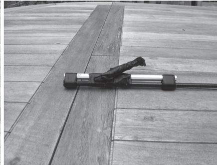
Abb. 2: Revolvergriff am hinteren Ende der Fangschlinge.
